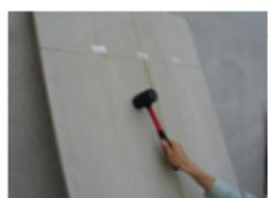
施工3時間後に試験板をゴムハンマーで60回振動させた。
